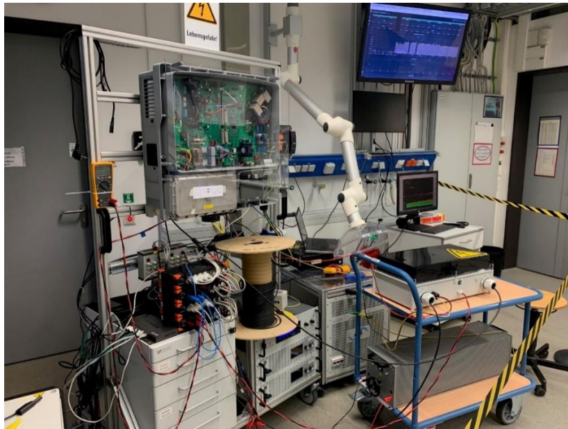
Abbildung 14: Power-Hardware-the-Loop Teststand zur Emulation von Fehlern und kritischen Zuständen in PV-Systemen
