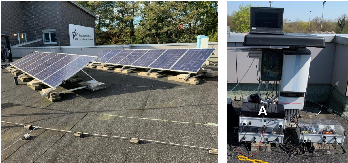
Abbildung 16: Dachanlage zur Untersuchung der Auswirkungen des Lichtbogenortes auf die Ableitstromcharakteristik: Solarpaneele (links), Messboxen (rechts) und Lichtbogen-generator (A)
