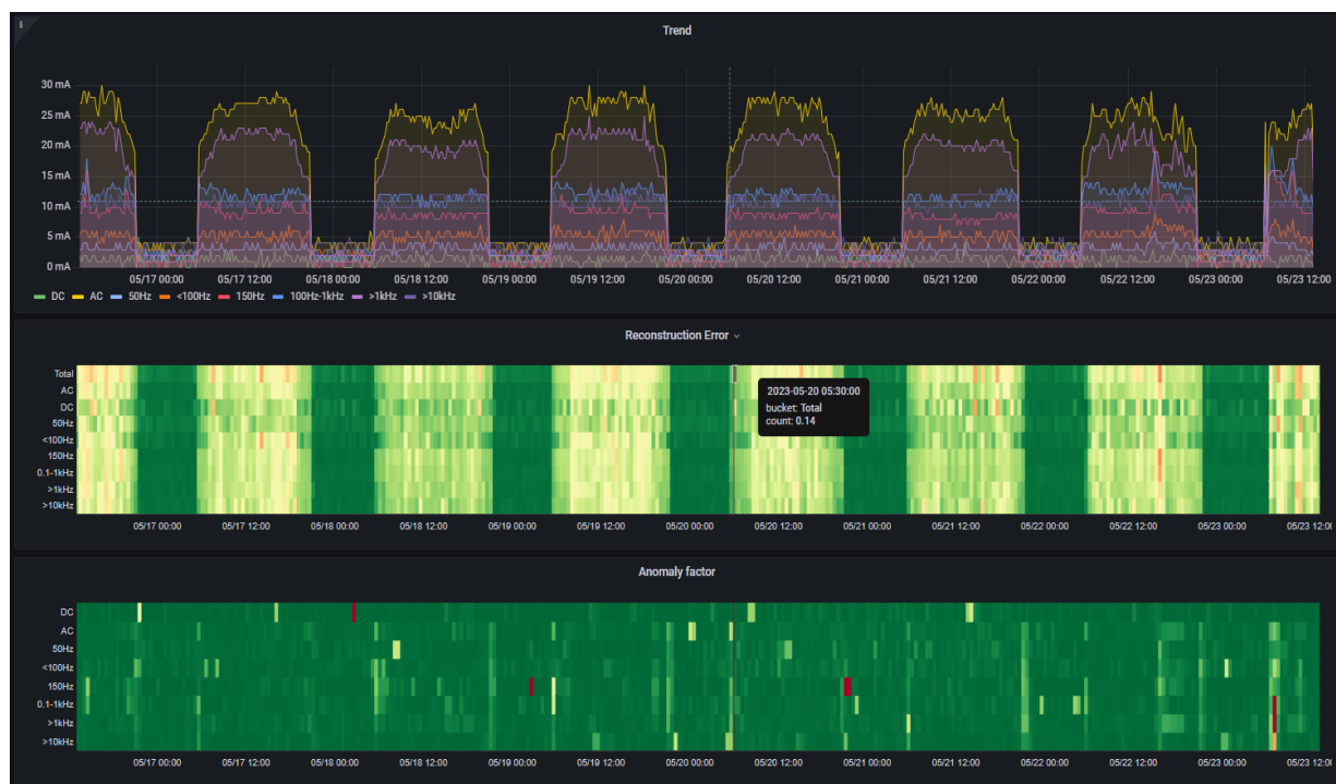
Abbildung 6: Beispielhafte Ableitstromsignaturen einer Aufdachanlage vom 17.05.2023 bis zum 23.05.2023
