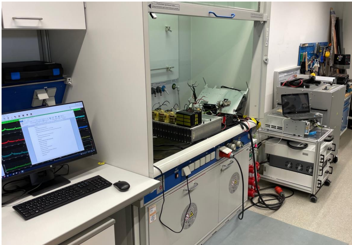
Abbildung 20: Laborteststand zur Untersuchung von Wechselrichterdefekten
