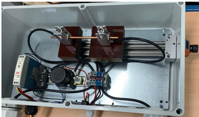
Abbildung 15: Innenansicht des im Rahmen des Projekts entwickelten Lichtbogengenerators.
