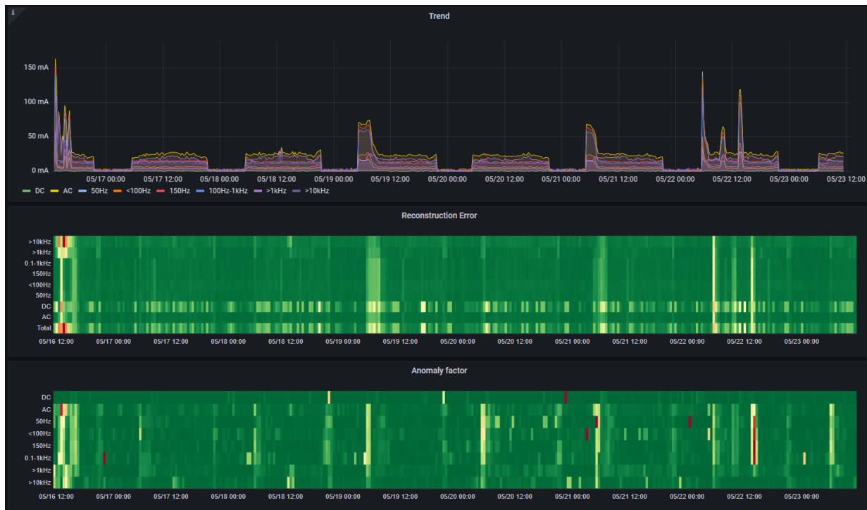
Abbildung 5: Beispielhafte Ableitstromsignaturen einer Freifieldanlage vom 17.05.2023 bis zum 23.05.2023
