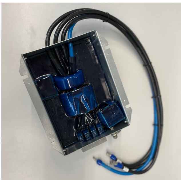
Abbildung 21: Filtereinrichtung zur Dämpfung der Oberwellen
